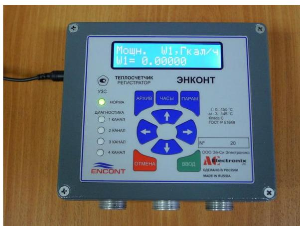
ИЗМЕРИТЕЛЬНЫЙ БЛОК (ИБ) - является основным функциональным элементом теплосчетчика и содержит электрические и электронные элементы для управления ультразвуковыми преобразователями расхода (УПР), приема сигналов с термопреобразователями сопротивления (ТС) и преобразователей давления (ПД).
