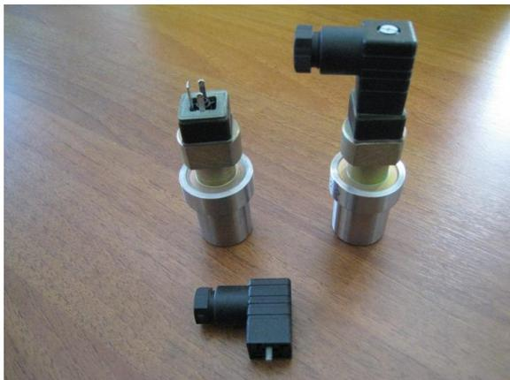
Пьезоэлектрические преобразователи ПЭП 3-4 (ПЭП 3-1, ПЭП 3, и т.п.) предназначены для создания в жидкостях ультразвуковых колебаний, их приема, с последующим преобразованием в электрический сигнал в составе ультразвуковых счетчиков жидкостей и (или) тепла.
