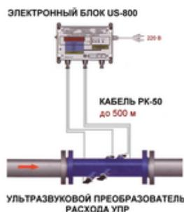
ЭБ (электронный блок) обслуживает один двухлучевой УПР, один канал измерения, на УПР врезаны 4 датчика (2 луча), отличается повышенной точностью 0.5-1%, требует минимум прямых участков при монтаже. Ду 100-2000 мм.
