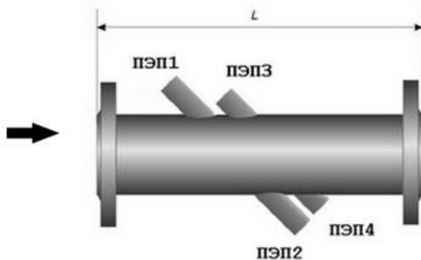
В двухлучевом УПР устанавливается две пары ПЭП, которые размещаются на осях параллельных друг другу и проходящих через равные хорды поперечного сечения.
