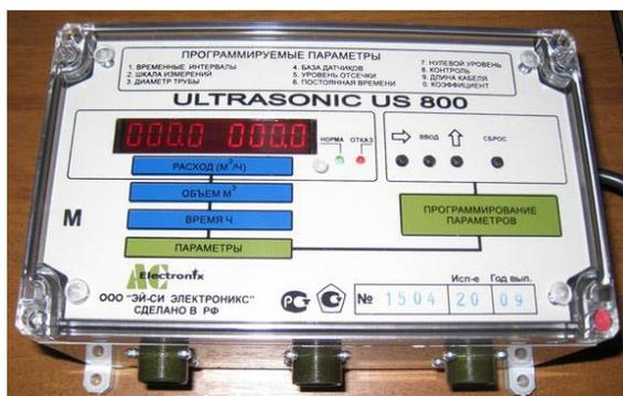
ЭЛЕКТРОННЫЙ БЛОК (ЭБ) - устройство, содержащее электронные узлы формирования и преобразования ультразвуковых импульсов, вычисления расхода, объема и вывода информации на основе измеренных времен распространения ультразвуковых импульсов.
